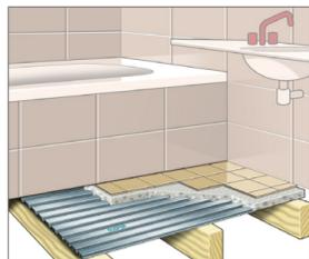
Aufgrund der Festigkeit und Steifigkeit des fertiggestellten Duofor Fußbodens sind Belastung, wie z.B. Punktlasten durch eine Badewanne, kein Problem. Da Schwalbenschwanzplatten aus Stahl hergestellt werden, fungieren diese auch als Bewehrung sowie Erdung. Ein zusätzlicher Armierung ist demnach nicht nötig.
