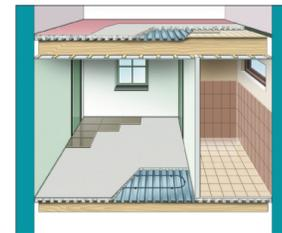
Ob Nasszellen, Erdgeschossböden oder Geschossböden; die Duofor Schwalbenschwanzplatten können, wegen ihrer dicken Zinkschicht, in jeder Räumlichkeit angewandt werden. Duofor Schwalbenschwanzfußböden haben eine minimale Haltbarkeit von 50 Jahren.
