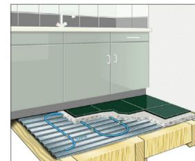
Die Fußbodenheizungsrohre werden auf die Schwalbenschwanzplatten befestigt. Die Heizungsrohre können mit Hilfe der Duofor DuoKlips eingeklickt werden. Für eine gleichmäßige Wärmeverteilung empfehlen wir, um zwischen den Heizungsrohre einen Abstand von 300 mm anzuhalten.
