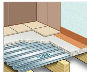
Die Randanschlüsse werden mit einem handelsüblichen Dichtband wasser- und durchlässig abgedichtet. Zuerst wird horizontal und vertikal zum Fußboden und zur Wand eine Schicht aus Dichtanstrich und Dichtband angebracht. Anschließend wird eine zweite Schicht des Dichtanstrichs aufgetragen. Danach werden die Fliesen verlegt und mit Silikon abgedichtet.
