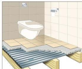
Duofor Schwalbenschwanzplatten werden direkt auf der Balkenlage angebracht. Die minimale Deckung liegt, je nach Achsmaß, zwischen 20 mm und 35 mm. Die Estrichschicht, die z.B. aus (leichtgewicht) Beton, Zementestrich oder einem Zementfließestrich besteht, wird direkt auf die Schwalbenschwanzplatten verteilt.
